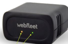
2 LEDs für System- und Verbindungsstatus
